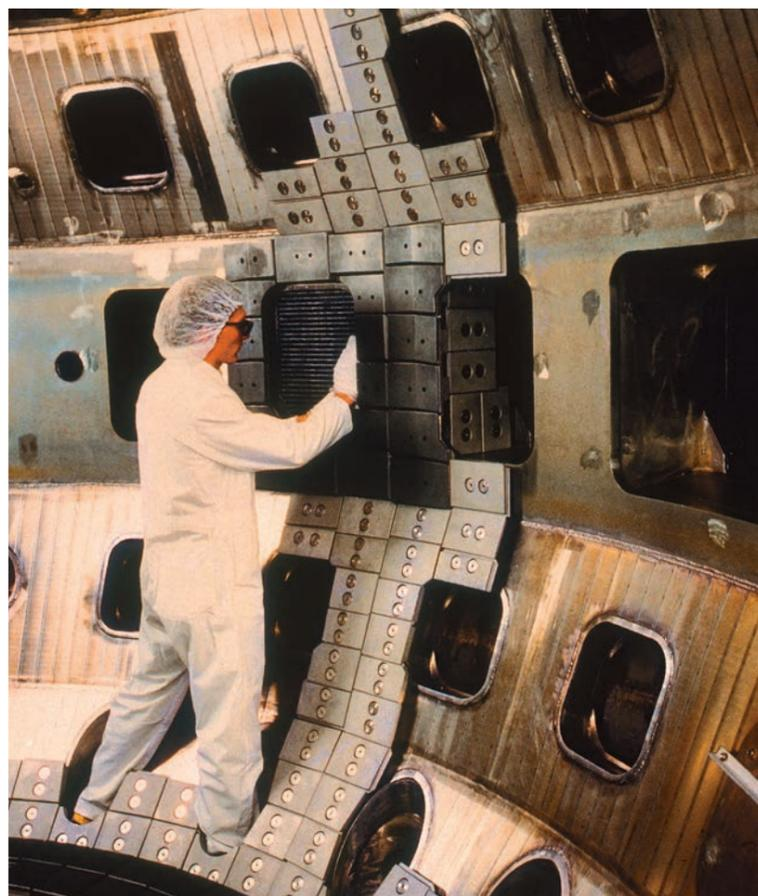
— Изучение возможности удержания плазмы в процессе управляемого термоядерного синтеза на токамаке Doublet III-D
