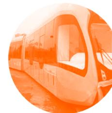
В 2017 году в китайском городе Чжучжоу открылась первая линия безрельсового электропоезда. Поезд с автономными рельсами может ездить по обычным дорогам, вмещает от 300 до 500 человек и способен развивать скорость до 70 км/ч.
