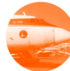
В СССР работы с водородным топливом начались еще в середине 1980-х годов. В Конструкторском бюро А. Н. Туполева создали и успешно испытали самолет Ту-155 с турбореактивным двухконтурным двигателем НК-88, предназначенным для работы на водороде.
